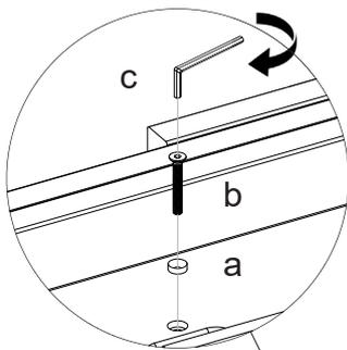
Træk bordpladerne fra hinanden, og brug 'c' til at montere de fire skruer ('b') og de fire hylstre ('a') som vist på tegningen.
